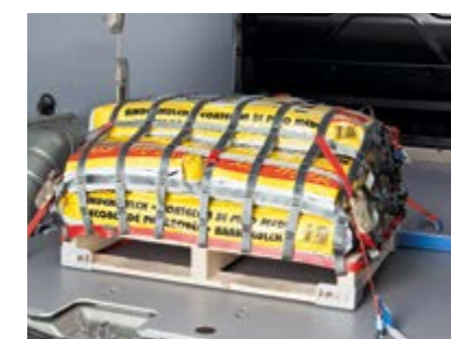
Kombinerat lastsäkringsnät och tvärbalkar
